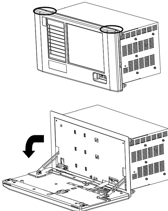
[図 3-1: フロントパネルの開け方]
