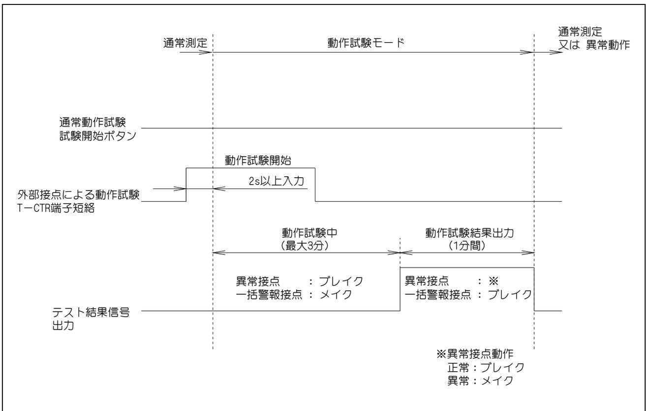
[図 10-1 : Igr 動作試験 / Io 漏電試験テストチャート]
