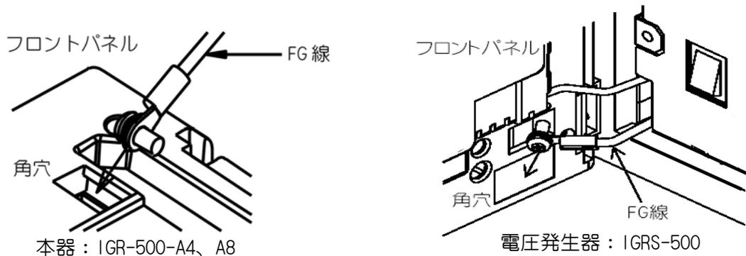
[図 12-1 : 耐圧試験時の FG 線の扱い]
