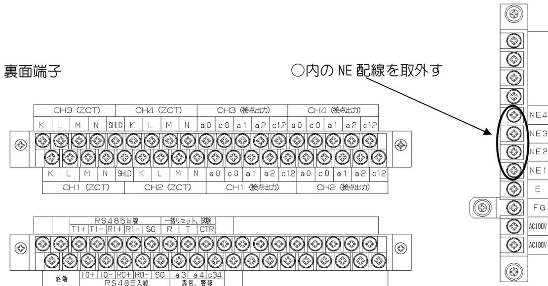
[図 12-2 : 耐圧試験時の NE 線の扱い(A4、A8 共通)]
