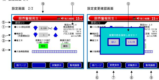
①CO<sub>2</sub>排出係数 設定 : CO<sub>2</sub>排出の換算係数を設定します。数値は↓ボタンで下がり、↑ボタンで
